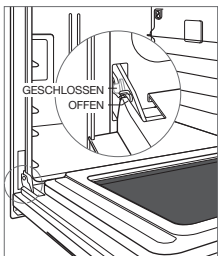
Ausbauen der Backofentür.
