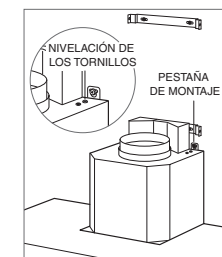
Montaje y nivelación de la campana.
