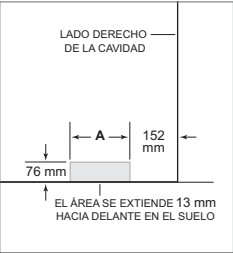
Ubicación del suministro de agua
