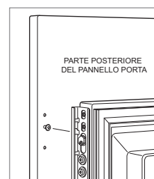
Montaggio pannello porta
