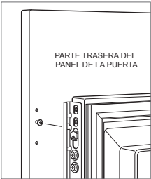
Montaje del panel de la puerta
