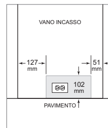
Posizionamento alimentazione elettrica
