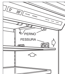
Installazione del diffusore luminoso.
