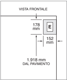
Posizione dell'alimentazione elettrica.
