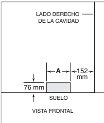
Ubicación de la toma de agua
