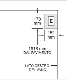
Posizionamento alimentazione elettrica
