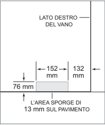
Posizionamento conduttura idrica
