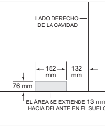
Ubicación de la toma de agua
