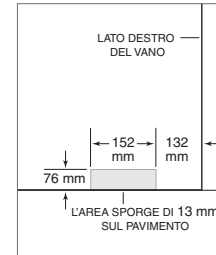
Posizionamento conduttura idrica.
