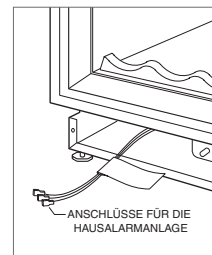
Anschluss für die Hausalarmanlage.
