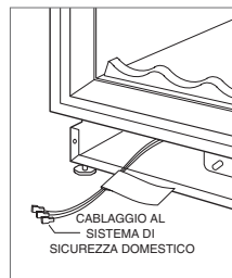
Cablaggio al sistema di sicurezza domestico.
