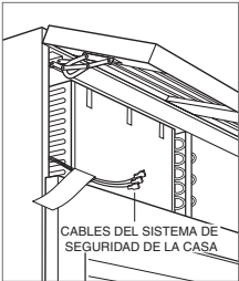
Conexión al sistema de seguridad de la casa.
