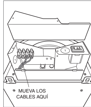
Ubicación del cableado
